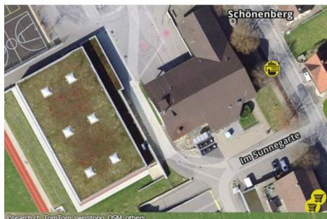
Das Bild beweist, das halbe Satteldach vom Dorfhuus zeigt nach Südosten. Das wäre für eine Solaranlage optimal. Geschätzt könnten 100 Solarmodule montiert werden, die eine Jahresleistung von etwa 30 MWh jährlich aufweisen. Das ist genügend Strom für 8 Familien. Noch optimaler und günstiger wäre die Installation einer Solaranlage auf dem Flachdach der danebenliegenden Sporthalle. Eine erste Schätzung weist auf eine mögliche Stromversorgung von weiteren 16 Familien hin.
